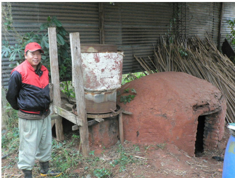
Horno para la preparación del ácido piroleñoso. Finca del Señor Daisaku Shibata
